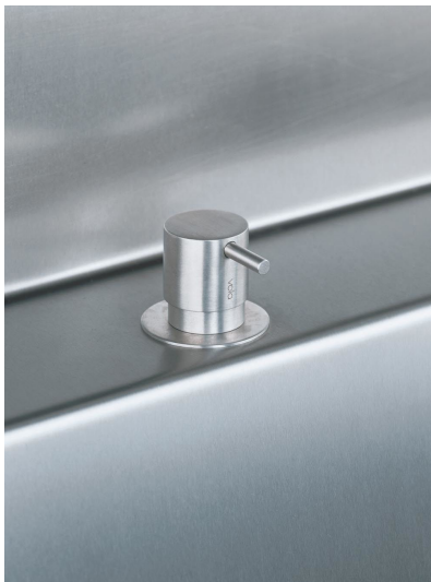
S50 Untertischventil für Wasch- oder Geschirrspülmaschinen, mit Rückflussverhinderer 1/2", für Kaltwasser, rechts öffnend, mit abschraubbarem Reduktionsnippel 3/4" / 1/2". Rosette 001G. Lochbohrung 30 mm.
