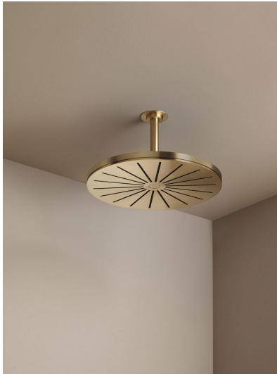
060A Runde Kopfbrause für Deckenmontage, einschl. 60 mm Abdeckrossette 001, Anschluss 3/4", Abstand Decke bis Unterkante Kopfbrause 165 mm, max. Durchflussmenge bei 3 bar 22 l/min.
