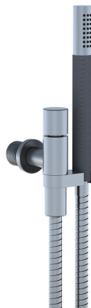
070R Wandanschlussbogen komplett mit Handbrause T2. Eigensicher durch integrierten Rückflussverhinderer, Brauseschlauch 1500 mm, Brausehalter rechts, Wandanschluss 3/4". Nicht für T60 geeignet.
