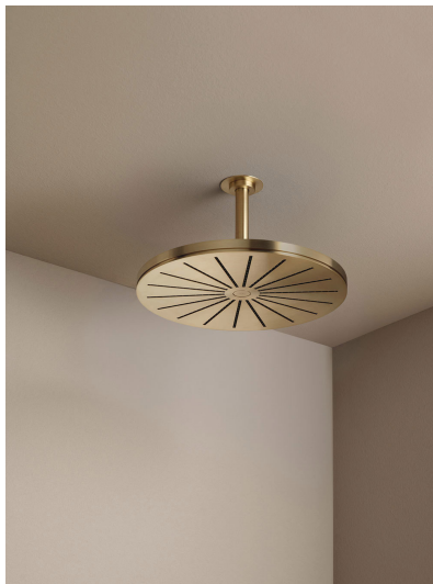
060A Runde Kopfbrause für Deckenmontage, einschl. 60 mm Abdeckrosette 001, Anschluss 3/4", Abstand Decke bis Unterkante Kopfbrause 165 mm, max. Durchflussmenge bei 3 bar 22 l/min.
