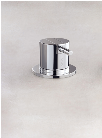
500 Eingriffmischer für Tischmontage. Edelmantel-Anschlusschläuche 3/8", Lochbohrung 42 mm für kleine Durchflussleistung wie z.B. Waschtischarmaturen.
