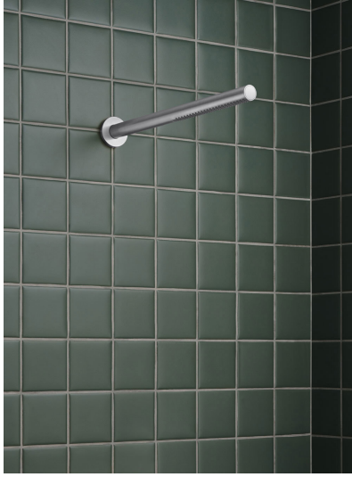
080ST Kopfbrause für Wandmontage, Anschluss 3/4", Gesamtausladung 500 mm. Max. Durchflussmenge bei 3 bar 25 l/m, inkl. Schubrosette.
