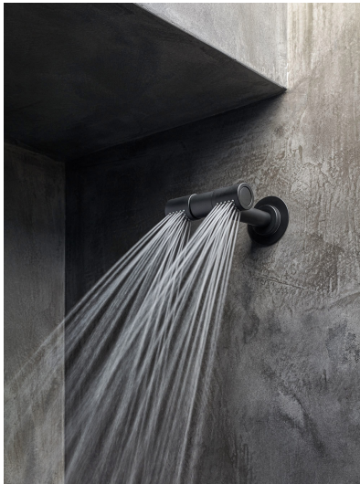
080D Kopfbrause mit zwei Brauseköpfen, Ausladung 130 mm einschließlich Abdeckrossette 001, max. Durchflussmenge 25 l/min bei 3 bar, Mindestdurchflussmenge 14 l/m.m.
